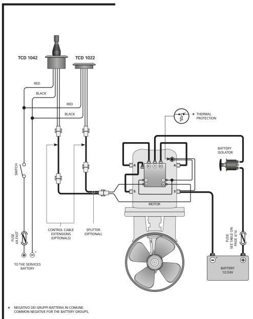
\*\* ATTENZIONE: IN CASO DI SOVRATEMPERATURA LA PROTEZIONE TERMICA SUL MOTORE SI APRIRÀ E INTERROMPERÀ IL CONTATTO NEGATIVO SUL TELERUTTORE. ATTENDERE IL TEMPO NECESSARIO ALLA RIATTIVAZIONE.
