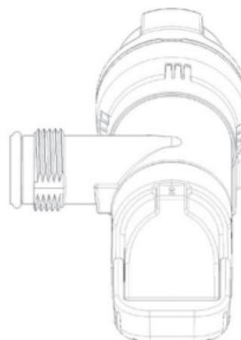
Veuillez noter que le clapet anti-retour NE DOIT PAS être utilisé avec un raccord coudé. Le débit peut être extrêmement réduit si on utilise ensemble un clapet anti-retour et un raccord coudé.
