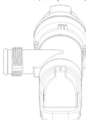
Recuerde que la válvula de retención NO debe usarse con el empalme de codo. La combinación de válvula de retención y codo restringen notablemente el caudal.
