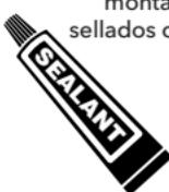
Todos los orificios de montaje deben estar sellados con un sellador apto para aplicaciones marinas para evitar la intrusión de agua.
