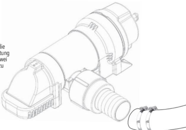
Für die Vorbereitung eines Wasserfahrzeugs für die Wintersaison ist es ratsam, das Rückschlagventil (sofern vorhanden) auszubauen und das gesamte Restwasser aus den Leitungen abzulassen.
