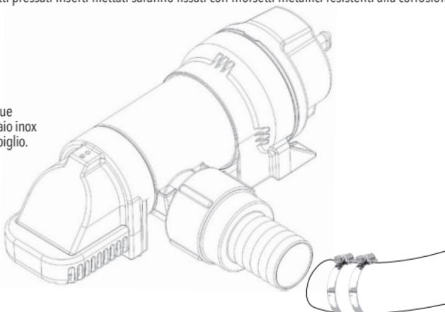
Durante la preparazione della barca per l'inverno, si consiglia di rimuovere la valvola di ritegno (se presente) e spurgare tutta l'acqua residua dall'impianto idraulico.
