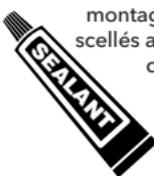
Tous les orifices de montage doivent être scellés avec un produit d'étanchéité de qualité marine pour éviter la pénétration de l'eau.
