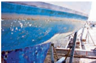
Blærer i og avskalling av maling
