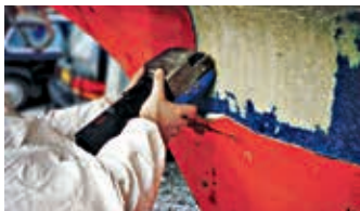
Fjerning av gelcoat med gelcoathøvel
