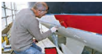
Påføring av vannlinjemaling
