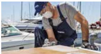
Sliping av treverk.
