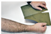
Kutt papiret slik at det passer til slipeklossen
