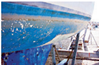
Blærer i og avskalling av maling
