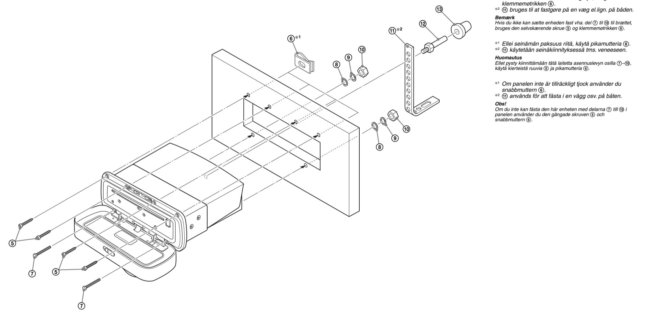
\*1 Hvis brættet ikke er tilstrekkeligt tyk, bruges klemmemotrikken ④.
