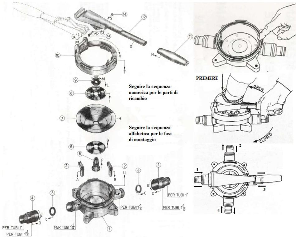
Sostituendo la membrana è consigliabile ungere il bordo superiore del corpo pompa con olio.
