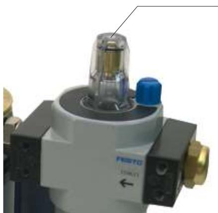
La regolazione della lubrificazione avviene agendo su questa piccola vite. Svitando la vite in ottone con un cacciavite a taglio, aumenta il flusso di olio ed aumenta di conseguenza la lubrificazione delle membrane.
