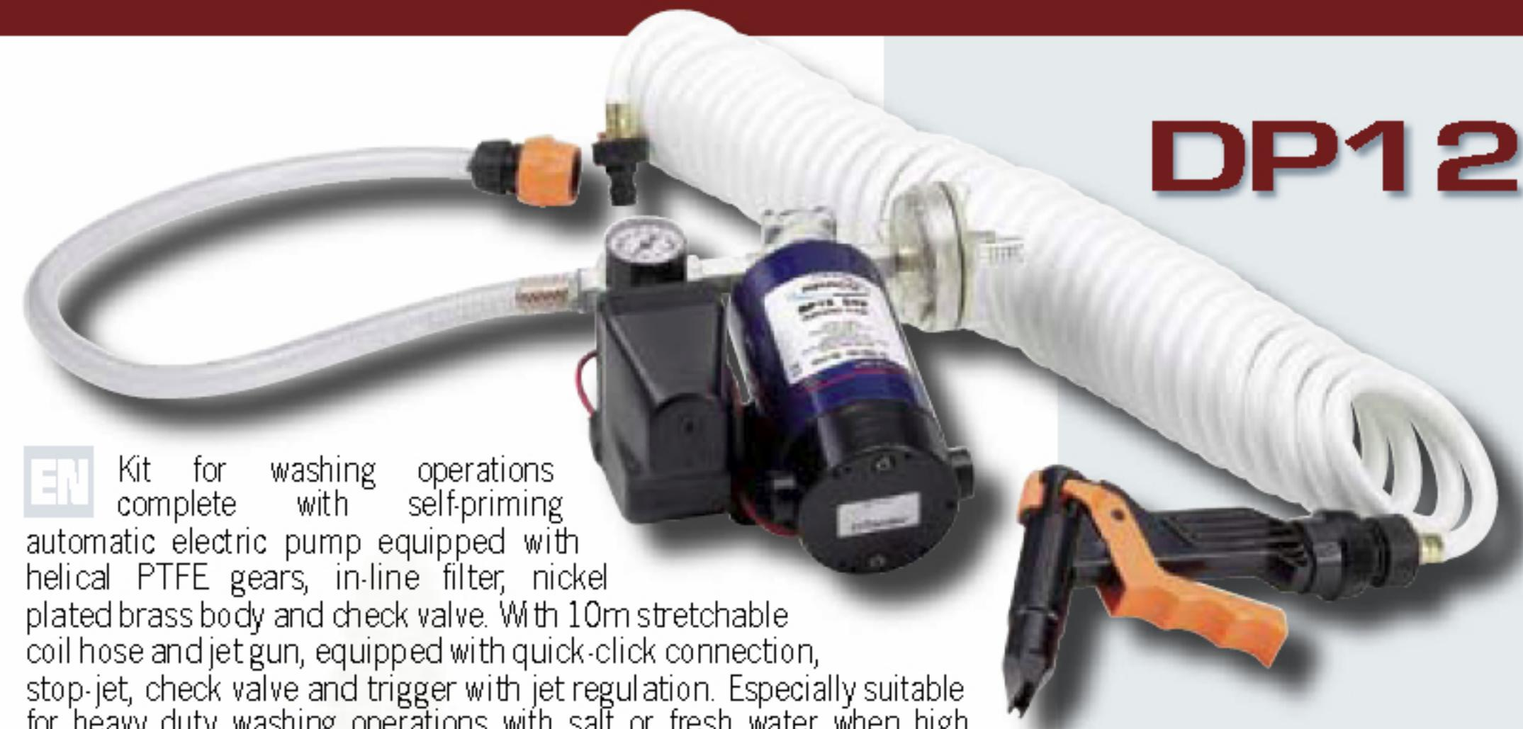
**IT** Kit di lavaggio completo di elettropompa automatica auto-adescante. Dotata di ingranaggi elicoidali in PTFE, filtro in linea, corpo in ottone nichelato e valvola di non ritorno. Con 10 m di tubo a spirale e pistola a spruzzo con connessione a scatto, blocco del getto, valvola di ritegno e grilletto con regolazione del flusso. Il kit è particolarmente adatto per operazioni prolungate di lavaggio con acqua dolce o salata dove sia richiesta in continuo un'alta pressione del getto.
